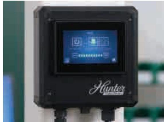
La pantalla táctil de alta resolución está hecha de vidrio resistente de grado industrial (similar a las centrales de alarmas de incendio). La mayoría de los edificios industriales ya disponen de red Ethernet, su comunicación con la pantalla táctil se realiza a velocidad IP.
