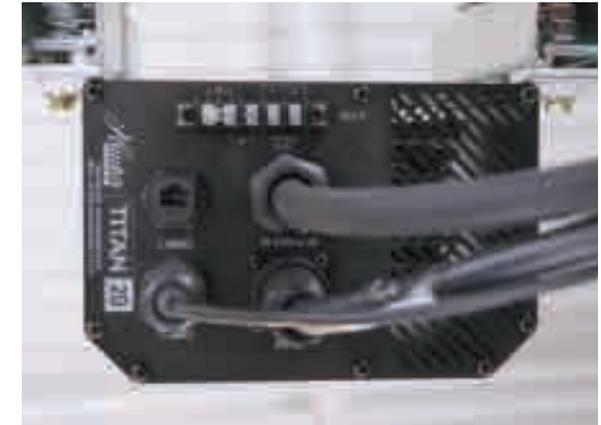
Nuestro VFD “variador de frecuencia” viene incluido con cada ventilador y está diseñado exclusivamente para motores de transmisión (BL-DC). Su instalación es “Plug & Play”. Ofrece un diseño que impide que esté expuesto a la disipación de calor. Utiliza una conexión Ethernet para la comunicación de red entre los ventiladores y la red informática.
